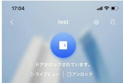
専用アプリケーションでの電子錠の制御、入退室の状況の確認が行えます。
